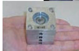
電子ペーパー向けツイストボール製造用マイクロリアクター (手のひらサイズ)
